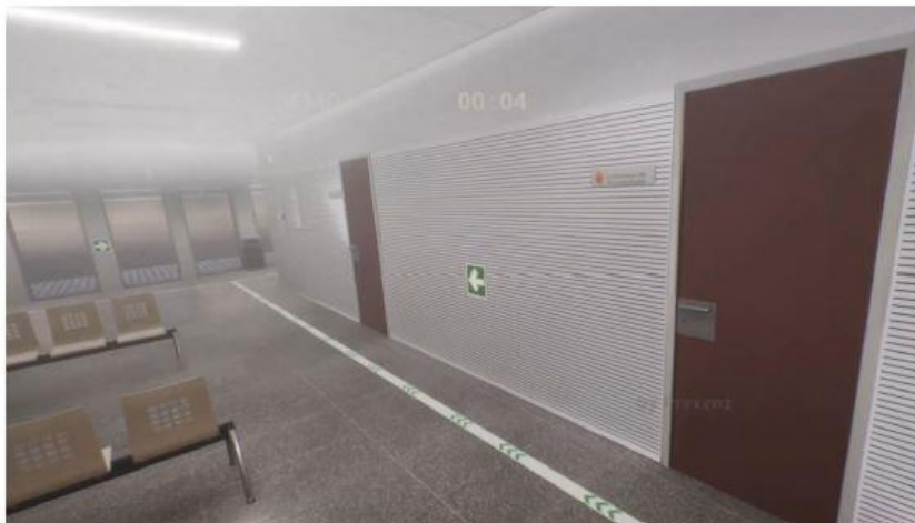
Itinerarios de evacuación en pavimento foto luminiscentes implementados en la zona de Consultas Externas
